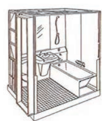
壁パネル、ドア器具類を取り付け完成
